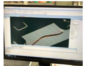
▲3Dスキャンした画面 ▼形状変化に合わせた溶接
